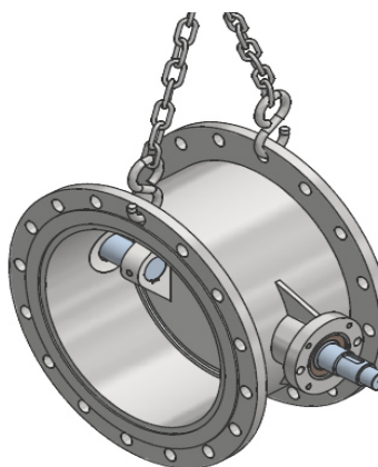
Abbildung 4-2: Anschlag an den Flanschbohrungen
